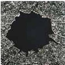
Gussglas wird thermisch vorgespannt, indem die Scheibe auf ca. 650 °C erhitzt und danach mit kalter Luft abgeblasen wird.
